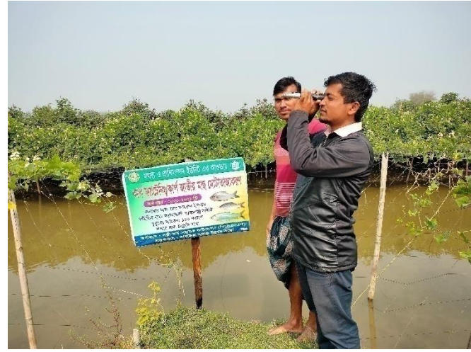
সংস্থার মৎস্য চাষীদের পুকুরে পানির স্যালাইনিটি পরীক্ষা করছেন প্রকল্পের সহকারী মৎস্য কর্মকর্তা
